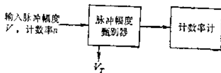
图4.1.7 脉冲幅度甄别器测量脉冲幅度
