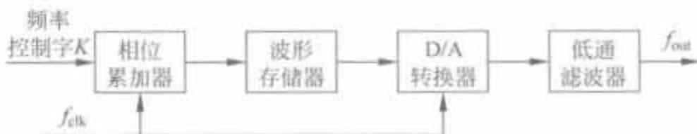
图 4-18 DDS 的结构框图
