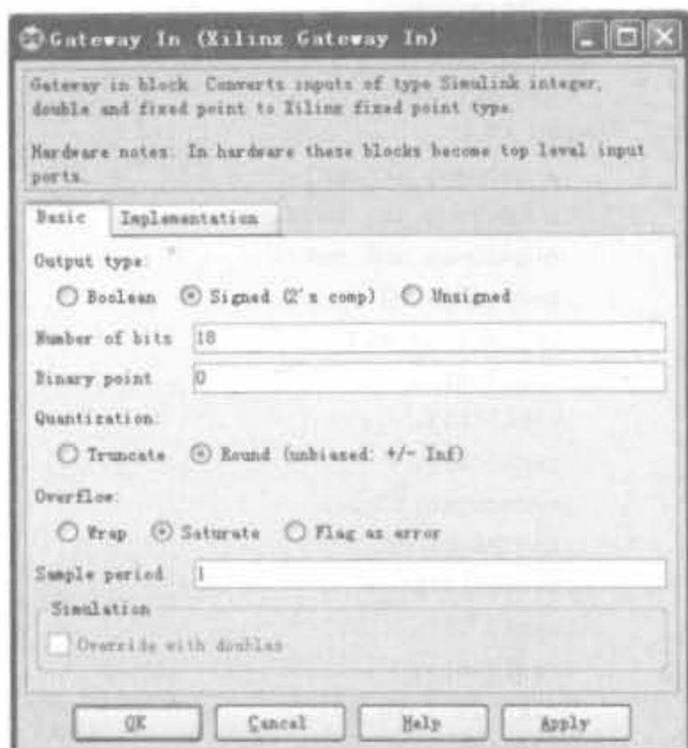
图 8-14 Gateway In 模块属性对话框
