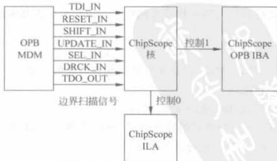
图 9-116 EDK 中 ChipScope 核的组成架构
