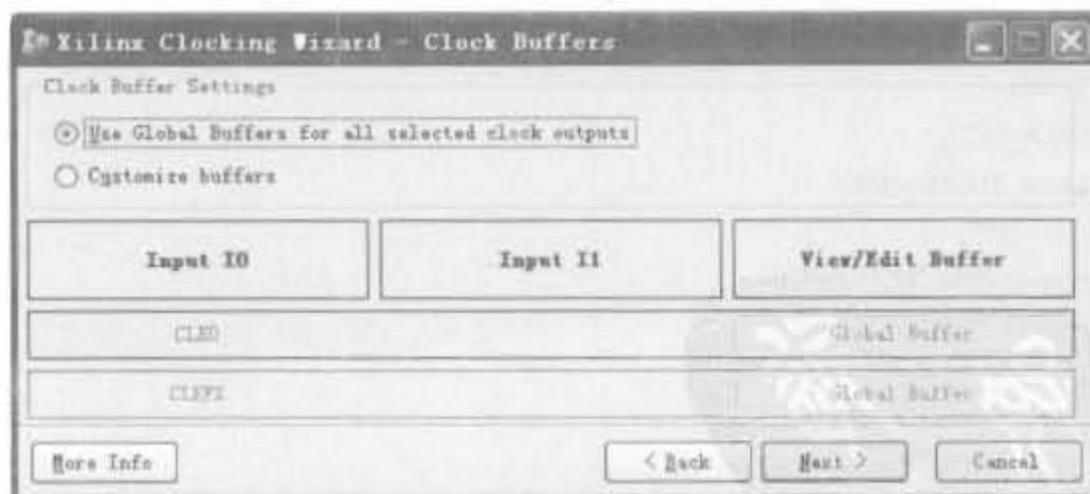
图 4-117 DCM 模块时钟缓存配置向导界面
