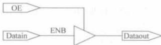
图 2-10 三态缓冲器的逻辑符号图
