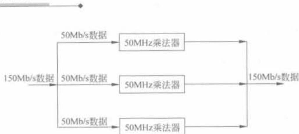
图 3-5 串/并转换的示意图
