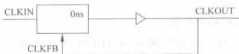
图 4-111 DLL 简单模型示意图
