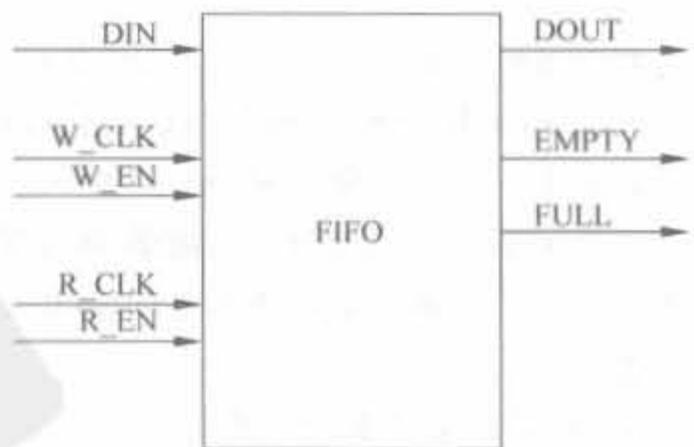
图 4-126 Xilinx FIFO 模块的示意模型
