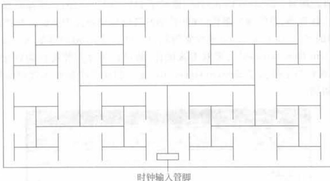
图 4-109 Xilinx FPGA 全局时钟分配树结构
