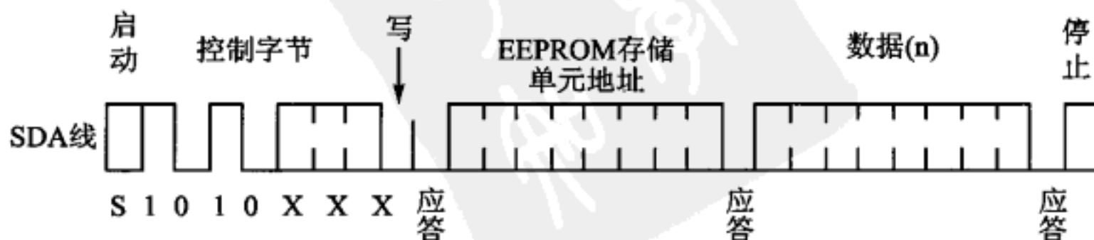
图 16.2 AT24C02/4/8/16 字节写入帧格式
