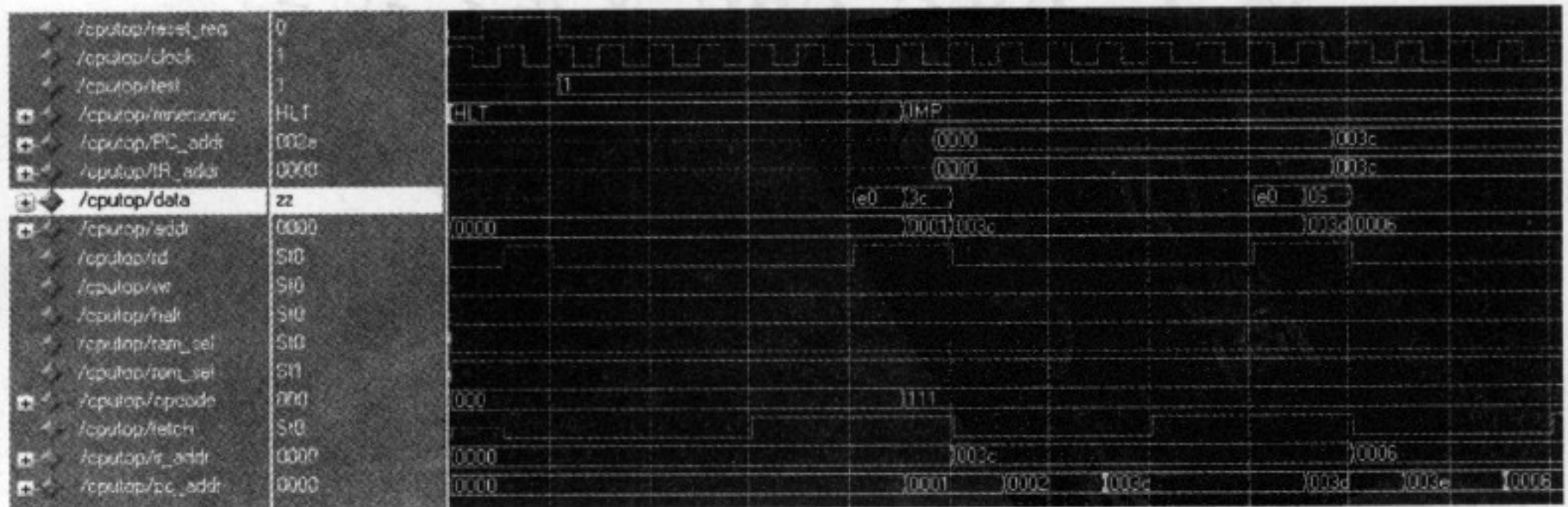
图 17.12 CPU 从存储器或端口读取数据的时序
