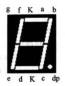
图 7-5 七段数码管引脚图
